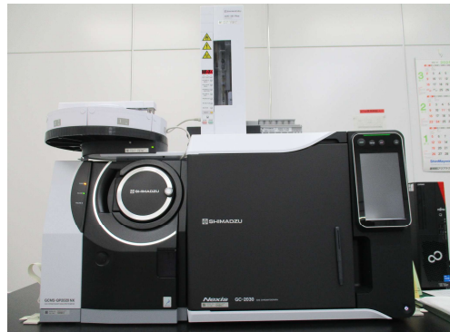
ガスクロマトグラフ質量分析装置 (島津製作所製GCMS-QP2020NX)
