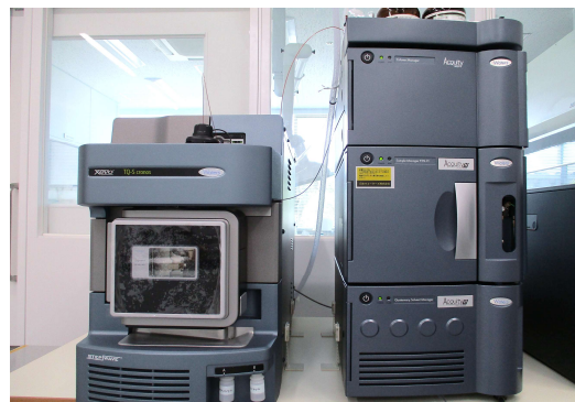
液体クロマトグラフ-タンデム型質量分析計 (ウォータースコーポレーション製 Xevo TQ-S cronos System)
