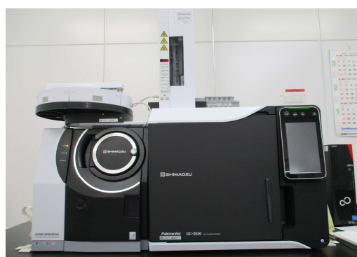
ガスクロマトグラフ質量分析装置 (島津製作所製GCMS-QP2020NX)
