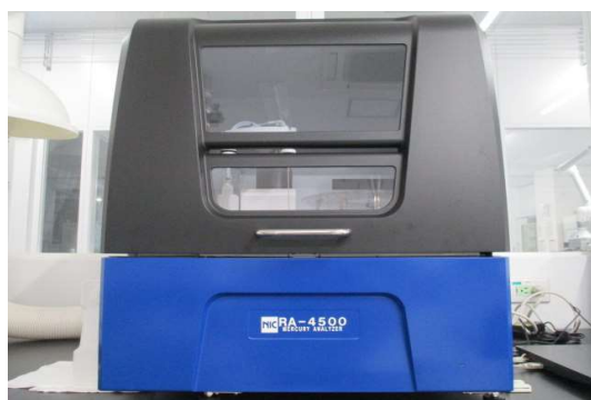
水銀分析装置 (日本インスツルメンツ製RA-4500)
