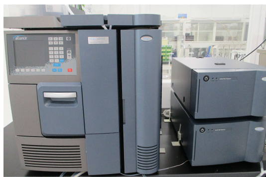
高速液体クロマトグラフ (ウォーターズコーポレーション製e2695)
