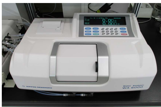
濁度色度計 (日本電色工業製WA 6000)
