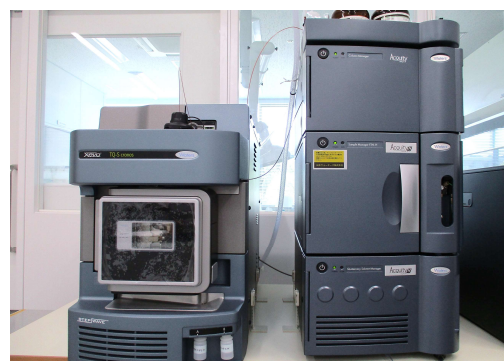
液体クロマトグラフ-タンデム型質量分析計 (ウォーターズコーポレーション製 Xevo TQ-S cronos System)
