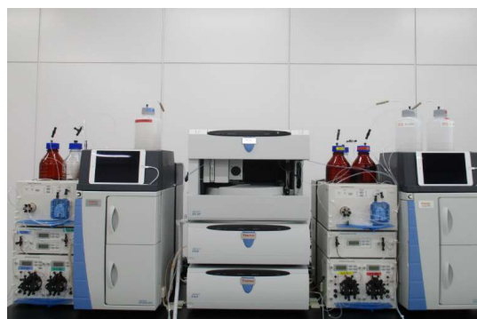
イオンクロマトグラフポストカラム分析装置 (サーモフィッシャーサイエンティフィック製 Dionex Integration、PCM-520)
