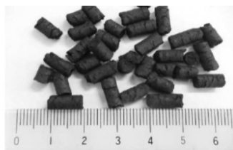
(左) 下水污泥固形燃料化施設と(右) 燃料化物(炭化固形物)
