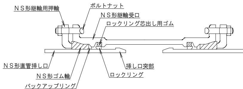
※規定の締付けを行ったT頭ボルトは白、押しボルト及びセットボルトには黄色のマーキングを行う。
