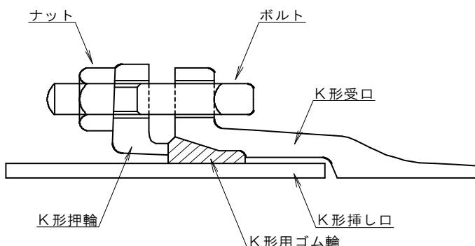
※規定の締付けを行ったT頭ボルトは白、押しボルトには黄色のマーキングを行う
