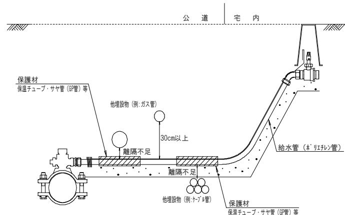
図 6-2 ロケーティングワイヤー施工図
