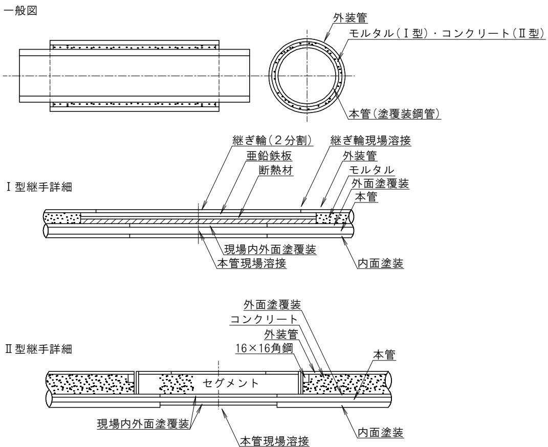
4. モルタル又はコンクリートの充填にあたっては、外装管に本管を挿入して均等な間隔を保つように組立てた後、モルタル又はコンクリートを完全に充填して一体化する。また、推進管は直射日光を避けるため、適当な保護材料及び保護方法により養生することとする。
