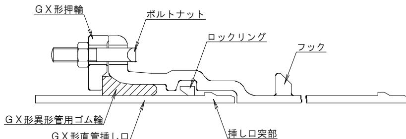
※隙間ゲージで確認後、T頭ボルトには白のマーキングを行う。
