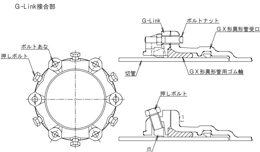
※隙間ゲージで確認後T頭ボルトには白、規定の締付けを行った押しボルトには黄色のマーキングを行う。
