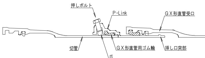
※規定の締付けを行った押しボルトには黄色のマーキングを行う。
