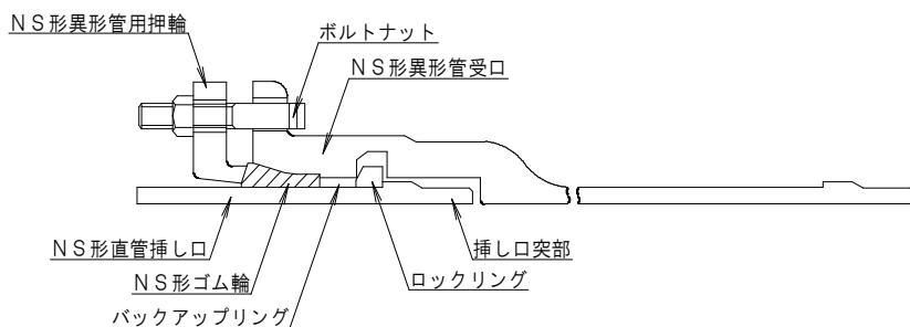
※規定の締付けを行ったT頭ボルトは白、押しボルトには黄色のマーキングを行う。
