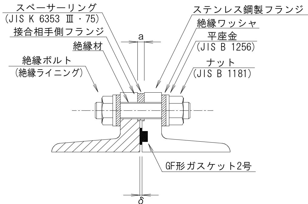
スペーサーリングを用い、図9-3に示すような隙間管理を行うが、通常 $\sigma$ の管理は困難なので、 $\alpha$ により管理を行う。管理の参考値を表9-3に示す。
