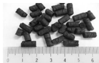
(左)下水汚泥固形燃料化施設と(右)燃料化物(炭化固体物)
