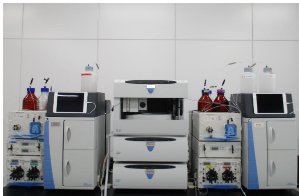
イオンクロマトグラフポストカラム分析装置 (サーモフィッシャーサイエンティフィック製 Dionex Integrion PCM-520)
