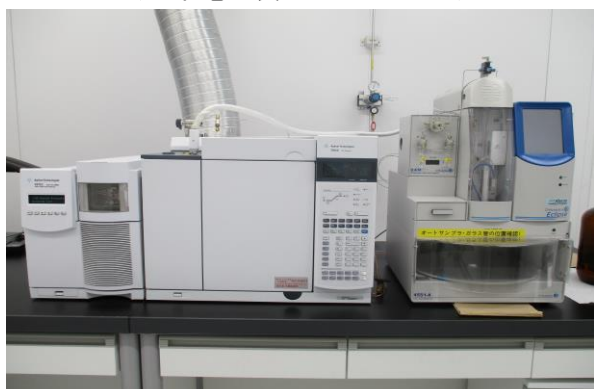
パージ・トラップガスクロマトグラフ質量分析装置 (アジレントテクノロジー製Agilent 5975C) (O・I・Analytical製Model 4660 Eclipse)
