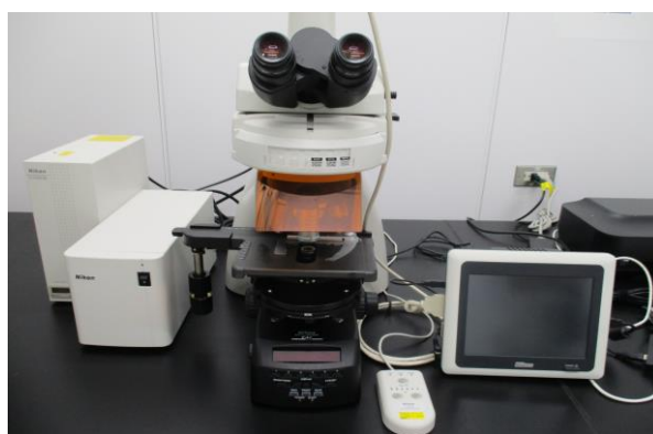
落射蛍光顕微鏡 (ニコン製Ni-E)
