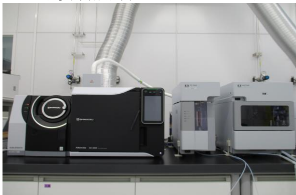
パージ・トラップガスクロマトグラフ質量分析装置 (島津製作所製GCMS-QP2020NX) (ジーエルサイエンス製PT7000)
