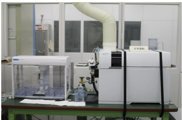
誘導結合プラズマ質量分析装置 (アジレントテクノロジー製Agilent 7800 ICP-MS)
