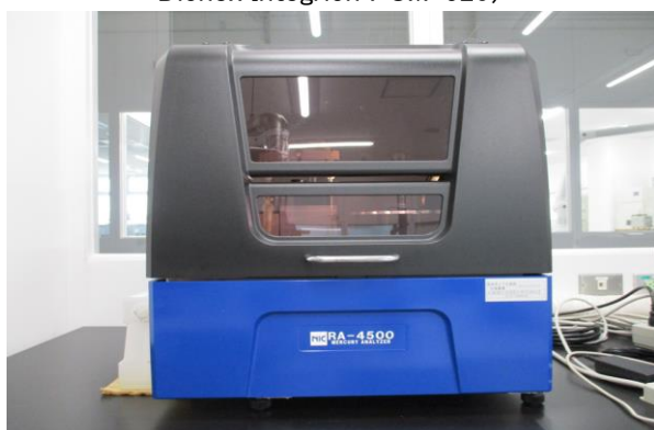
水銀分析装置 (日本インスツルメンツ製マーキュリーRA-4500)
