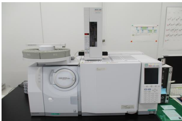
ガスクロマトグラフ質量分析装置 (島津製作所製GCMS-QP2010 Ultra)
