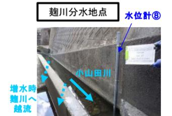
図 3-5 水位・流速設置箇所と目的
